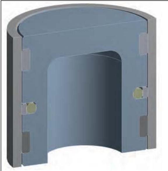
>>1: 3D-Ansicht des hydraulischen Dichtungssystems bestehend aus Kolben, Zylinder, O-Ring, Gleitringen und Dichtungsring
