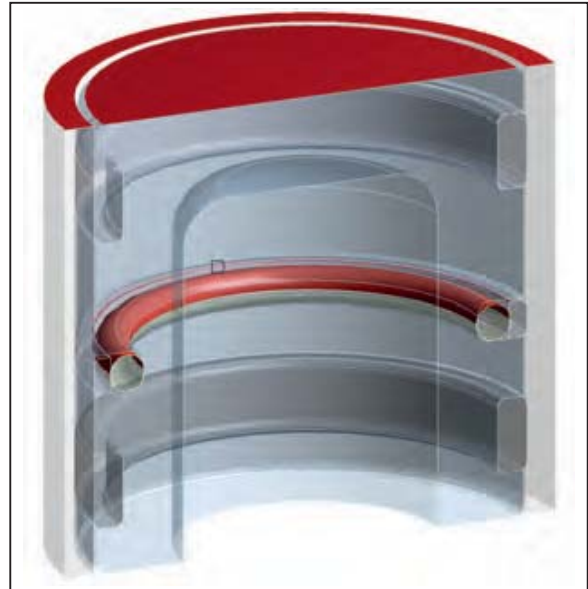
>>12: Die roten Flächen kennzeichnen die Startpunkte für die Fluid-Pressure-Last
