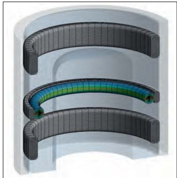
>>13: Globale Ansicht des Verzerrungszustands für die hyperelastische Dichtung nach dem 1. Lastschritt
