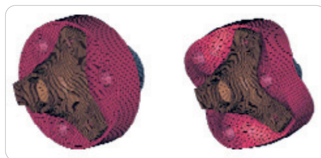
Bild 3: Gelenkscheibe während eines Frontal-Offset-Crashes.
