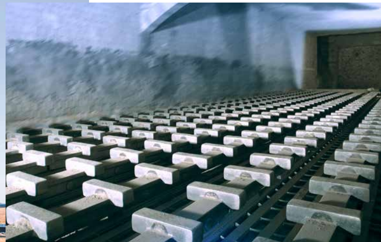
Bild 2: Das Polytrack-Fördersystem kühlt und transportiert den Zementklinker.
