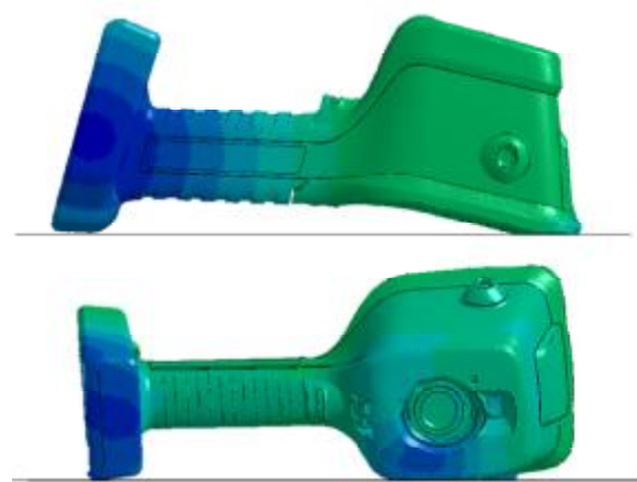
Bild 3: Je nach Aufprallposition ergeben sich unterschiedliche Deformationszustände.
